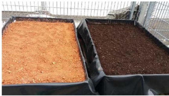
Abbildung 2 Lysimeter 1 (ZBA) und Lysimeter 2 (ZBA mit Lavamulch versetzt)
