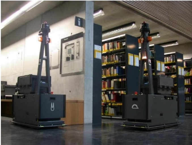
Abbildung 1: Transportroboter Hase und Igel in der Zweigbibliothek Naturwissenschaften der UB der HU Berlin (Herwig, 2021, https://www.ub.hu-berlin.de/de/standorte/erwin-schroedinger-zentrum-zwbib-nawi/standort-informationen/technik-1/fahrerloses-transportsystem-fts-1.html )
