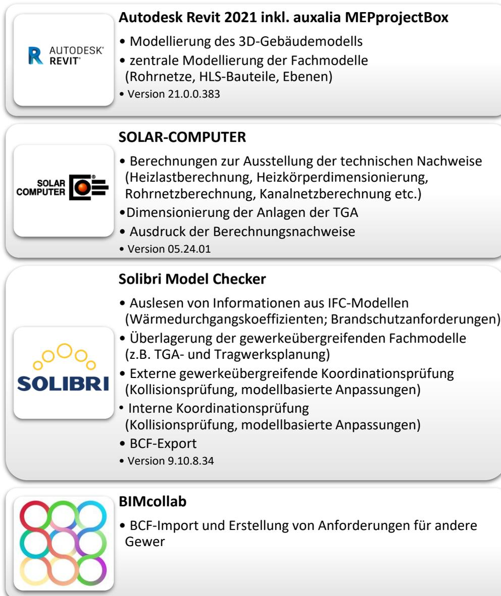
Abbildung 2.2: Verwendete Modellierungs- und Berechnungsprogramme für die Konzeptionierung des BIM-Workflows
